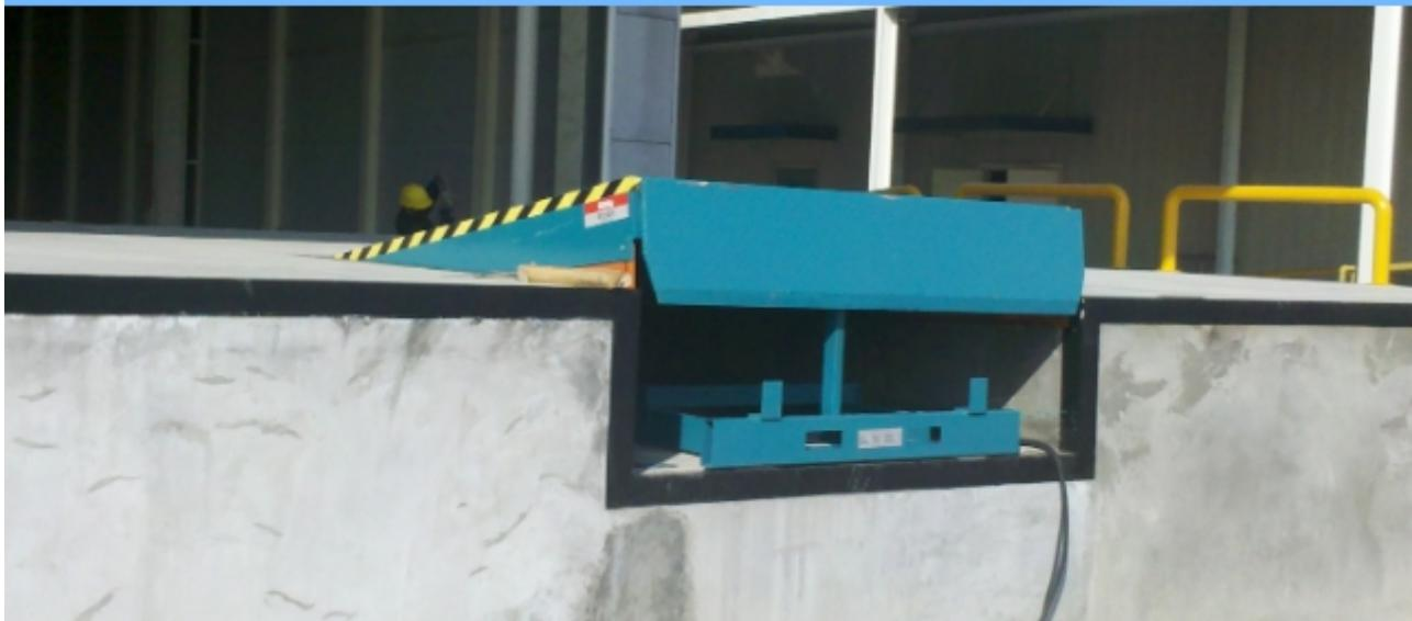
搬运叉车不能进出运输车辆直接装卸货物。使用移动式登车桥时可根据货车车厢高度不同任意调节，固定式登车桥，升降方式分为电动和手动。移动式登车桥特点：全液压动力，单个按钮操作两侧安全防护裙保护脚部安全唇板与车厢始终紧密吻合平台与唇板采用长轴铰链，南阳登车桥，移动式登车桥充分保证其\*\*度、长寿命附设检验安全撑竿及缓冲垫移动式登车桥与月台和为一体，在仓库和车辆之间搭起桥梁，移动式登车桥广泛应用于多种车型的企业、仓库、车站、码头、邮政运输、物流配送等场所。移动式登车桥单体，在仓库和车辆之间搭起桥梁，辅助叉车或其他运输设备装卸货物。叉车或其他运输设备可通过桥面驶入车厢内部功课，液压登车桥生产厂家，省时省力，极大的进步了工作效率。使用时可根据货车车厢高度不同任意调节，升降方式分为电动和手动。
